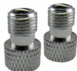
Set de 2 adaptadores de válvula Presta (fina) a Schrader (gruesa), fáciles de instalar, simplemente roscándolos sobre la válvula Presta. es un accesorio útil para poder hinchar nuestras ruedas con válvula fina con cualquier compresor de gasolinera, y así también poder comprobar la presión de las ruedas con cualquier manómetro. Con junta tórica para evitar fugas de aire. En color plata.
