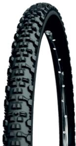
Una cubierta clásica de mtb XC. Con un taqueado contundente, proporciona buen agarre y retención de frenada en todo tipo de terrenos. Es una excelente elección para un uso ocasional de la bicicleta de montaña o para rueda trasera en uso intensivo por caminos y vías verdes incluso en mojado y con barro.
