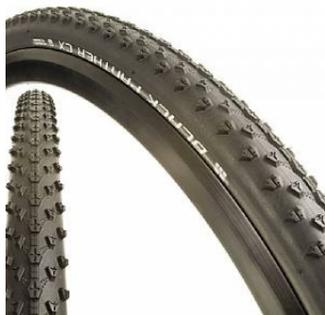
Cubierta de 29" todoterreno con una estructura de 5 hileras de tacos. Agarra bien y proporciona estabilidad. Fabricada con triple compuesto de alta calidad para dotar al neumático de un buen índice de agarre. Los tacos de la hilera central están encadenados para tener una baja resistencia al rodaje.
