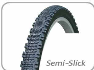
Cubierta de mtb también utilizada para trekking. Combina un buen agarre lateral y estabilidad en curva gracias a sus tacos en los flancos con un buen rodar debido al diseño semi-slick de su banda de rodadura. Ideal para excursiones por caminos y una utilización habitual por asfalto o pavimento.
